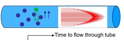
**Diffusion time (wall to wall): 40 min** (D  $\sim$  5 x 10<sup>-9</sup> m<sup>2</sup>/s)
